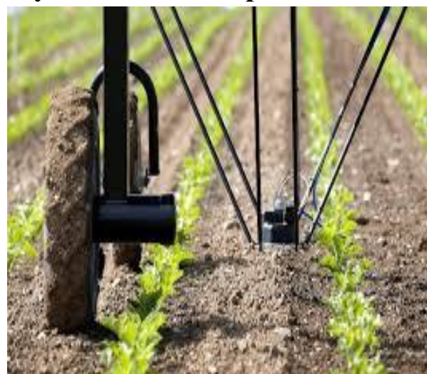
2.4.19-расм. Экороботнинг бегона ўтни йўқотувчи қурилмаси
